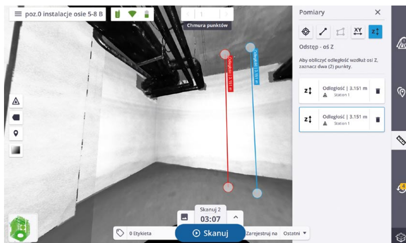
Rys. 1. Trimble Perspective – wykonywanie pomiarów w terenie (opracowanie własne)
