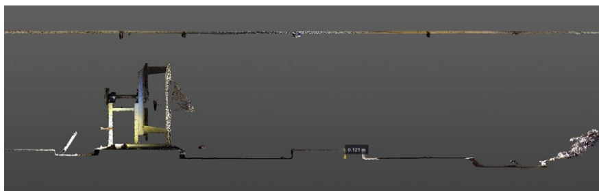
Rys. 4. Przekrój przez chmurę punktów wentylatorni (opracowanie własne)
