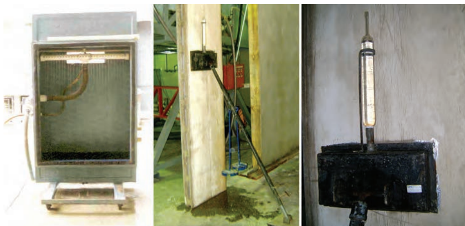
Figura 25 – À esquerda câmara para ensaio de estanqueidade de fachadas em laboratório. À direita pequena câmara para ensaio de paredes internas ou faces internas de fachadas voltadas para áreas molhadas da edificação (Fonte IPT).
