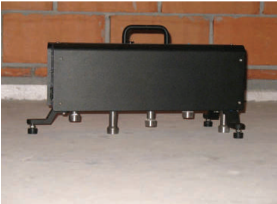
Figura 20 – Equipamento padronizado para ensaios de ruídos de impacto em pisos.
