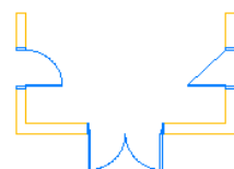
drzwi z prostym otwarciem określonym we właściwościach wyświetlania drzwi
