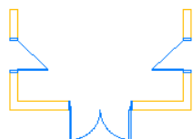
drzwi z prostym otwarciem określonym we właściwościach wyświetlania stylu drzwi
