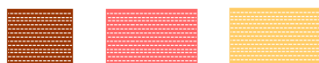
Kreskowanie powierzchni elewacji 2D o materiałach, kolorze i rodzaju linii pochodzących z definicji podpodziałów
