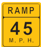
Velocidad recomendada en la rampa
